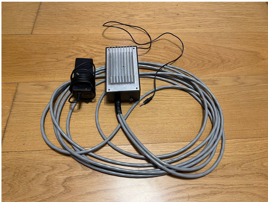
Рис. 1. Общий вид устройства: корпус с внешним радиатором, кабель катушки и кабель питания
